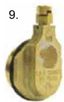
Vat veiligheidsventiel 2" voor drukvereffening bij aftappen. Opent automatisch bij 0.35 bar. Soupappe de sécurité pour fût 2" par ouverture sous pression. S'ouvre à 0.35 bars.
